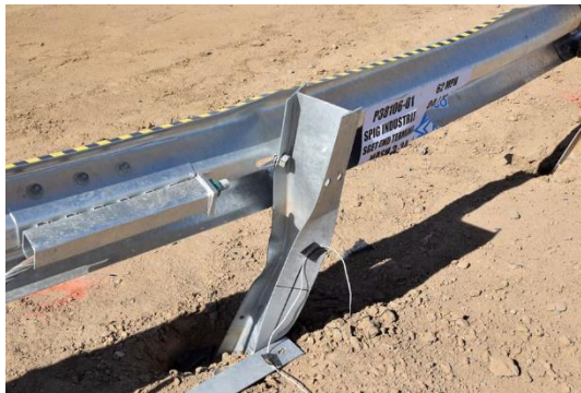
FIGURA 34. Danos ao Artigo de Teste
