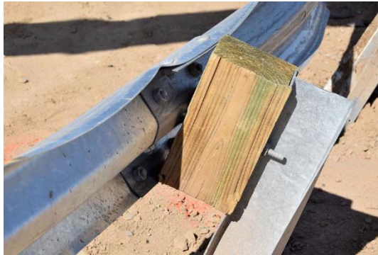
FIGURA 36. Danos ao Artigo de Teste
