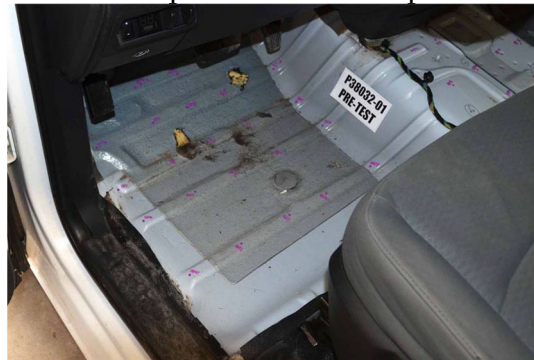
FIGURA 51. Pré-Teste - Chapa de Assoalho no Lado do Condutor
