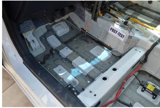
FIGURA 51. Pós-Teste - Chapa de Assoalho no Lado do Condutor
