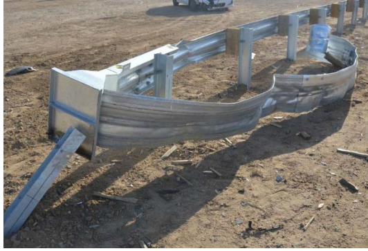
FIGURA 31. Danos ao Artigo de Ensaio
