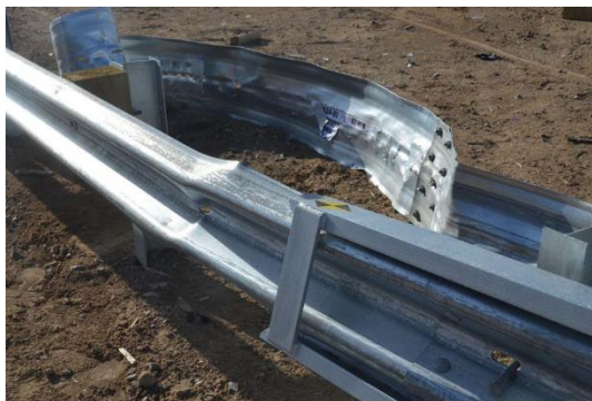
FIGURA 34. Danos ao Artigo de Ensaio
