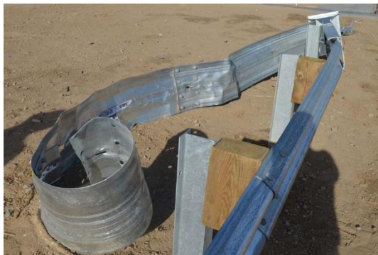
FIGURA 33. Danos ao Artigo de Ensaio
