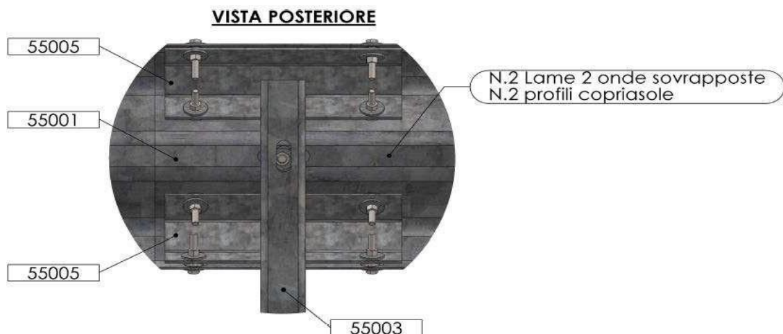
Figura 9: Conexão faixas laterais -perfis cobertura
