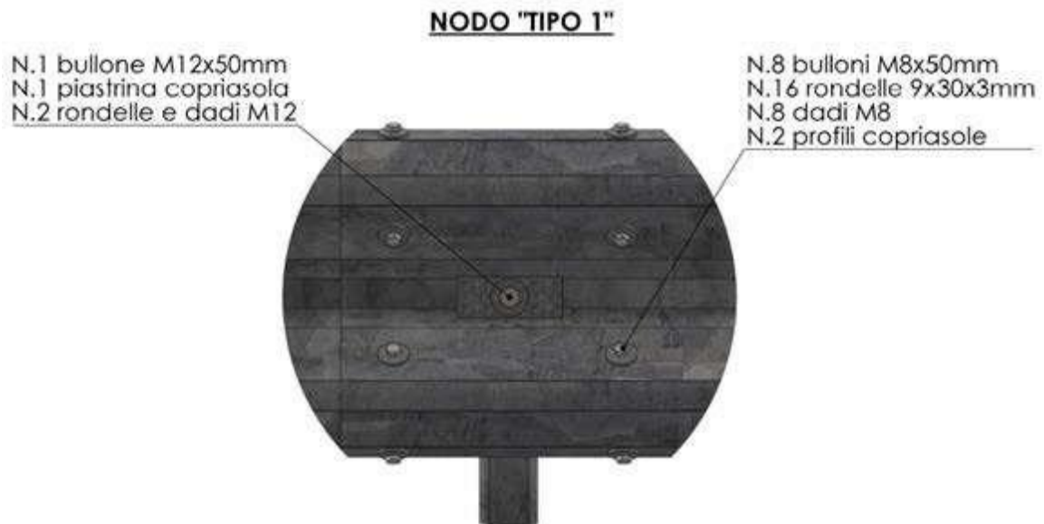
Figura 15: Detalhe nó "Tipo1"
