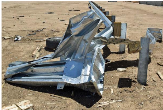
FIGURA 34. Danos ao Artigo de Teste
